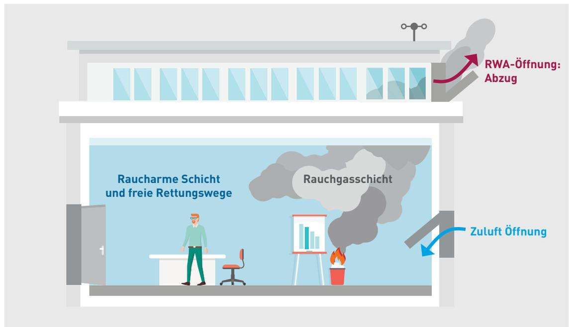
**Der natürliche Rauch- und Wärmeabzug ist eine, aus mehreren Komponenten bestehende, komplexe Anlage.**
