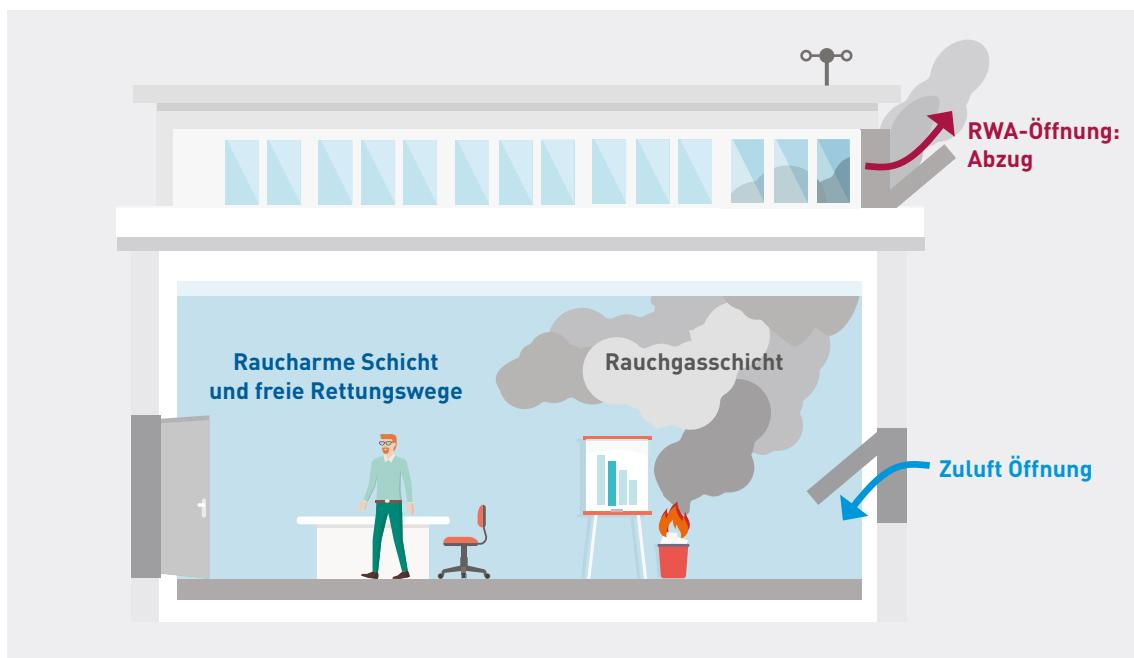
**Der natürliche Rauch- und Wärmeabzug ist eine, aus mehreren Komponenten bestehende, komplexe Anlage.** Die Steuerung bildet das Kernstück dieser Anlage, an die Aktoren, wie z. B. ein elektrischer Antrieb oder Pneumatikzylinder, und andere Komponenten angeschlossen werden. Im Brandfall aktiviert die Steuerung die Aktoren, um über die Öffnungsbewegung für den notwendigen Rauchabzug über Fenster, Lichtkuppeln, Lamellen oder Lichtbänder zu sorgen.
